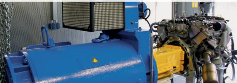
Das Fraunhofer-Institut für Verkehrs- und Infrastruktursysteme IVI betreibt einen Versuchsstand, in welchem Dieselmotoren, elektrochemische oder elektrostatische Speicher (Batterien, Kondensatoren) geprüft und getestet werden. Die Prüfeinrichtungen können separat oder im Verbund arbeiten. Hierdurch sind Untersuchungen hybrider Antriebsstränge von Nutzfahrzeugen möglich.
